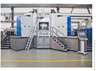
的加工特点,在切割过程中机床会产生明显的振动,航空应用的这些特点对加工是非常不利。另一方面,形状复杂的航空发动机零件需要从立式车床操作快速切换到传统的立式机床操作,在单个机床中组合铣削和车削能够确保高生产效率和精度。
